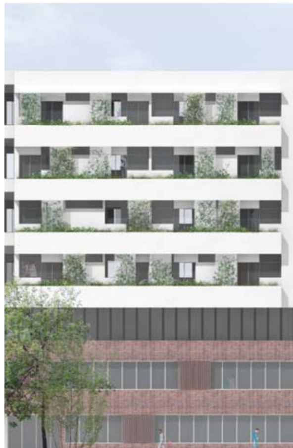
Grøn facadebeklædning der, udover at bringe det grønne i øjenhøjde for patienterne, vil kunne virke filtrerende for de pollen der tilføres via luften.
